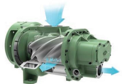
*La serie LS de Sullair es la primera en ofrecer operación con válvula en espiral electrónica junto con compresores de Sullair. Las válvulas en espiral electrónicas ofrecen una mayor precisión en comparación con las válvulas en espiral de accionamiento manual.*
